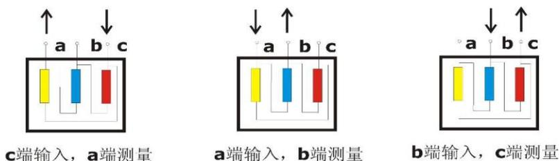
由于内连接 Δ 接线非测量的两个绕组串联后并联在回路中，理论上说对测试过程是有影响的。如果衰减超过 10dB 后，则可以认为非测量线圈的影响可以忽略。
