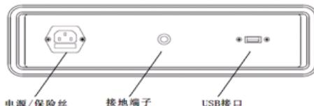
图 1b 变压器绕组变形测试仪后面板图(后面板)
